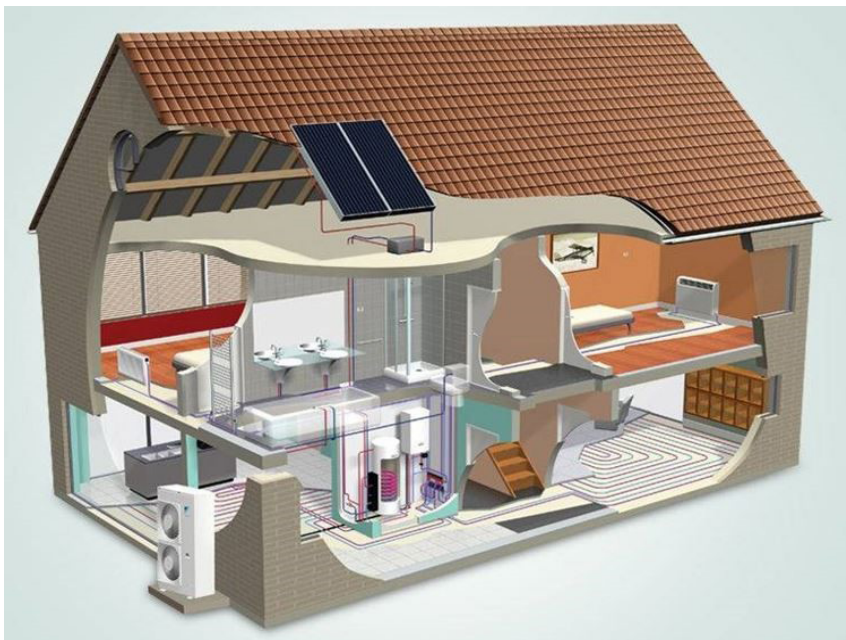
Fig. 1 La pompa di calore come elemento centrale di un sistema integrato
