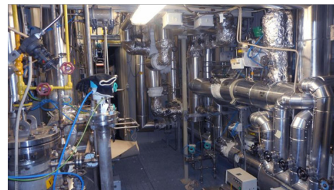
Fig. 3 Impianto CoMETHy per la produzione di idrogeno mediante steam reforming a bassa temperatura alimentato da calore solare (Centro Ricerche ENEA Casaccia)
