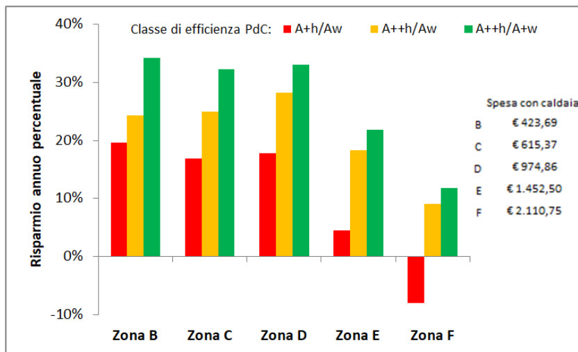
Fig. 3 Risparmio annuo percentuale per riscaldamento e produzione acqua calda sanitaria con una pompa di calore rispetto a una caldaia a gas a condensazione
